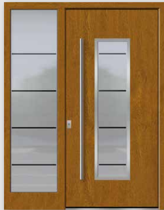
Argo 6E . PG 3 flügelabdeckendes Türblatt, Holzdekor, Haustür und Seitenteil Glas „Baku“, Klarglas mit Teilmattierung, außen Edelstahlrahmen, innen ohne Rahmen, Griff Merkur 1600 mm, PZ-Rosette mit planflächigem Schlüsselschutz
